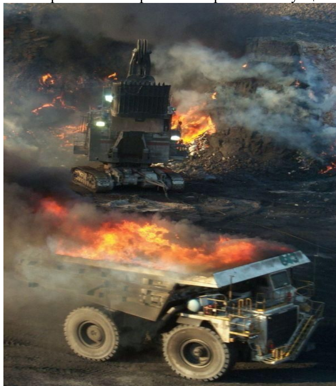
Рис. 1. Выемка на опережение участка самовозгоревшегося угля и транспортировка горящего угля на спецплощадку [4]
